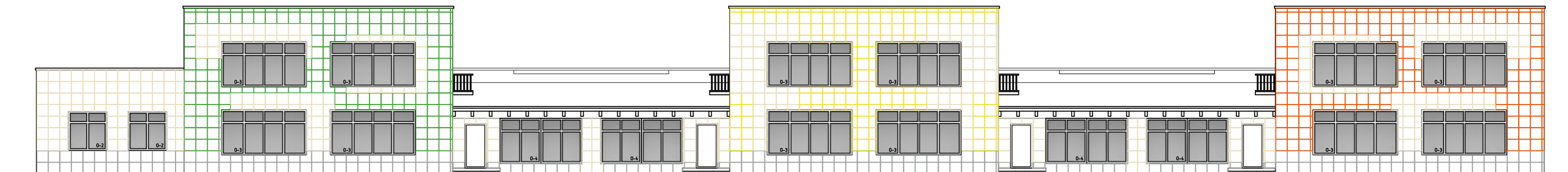
ФАСАД В ОСЯХ 9-1 (схема раскладки фасадных панелей)
